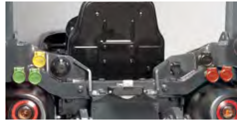
Hydraulikanlage mit einem einfachwirkenden und zwei doppeltwirkenden Verteilerventilen und Ölrückflussanschluss.
