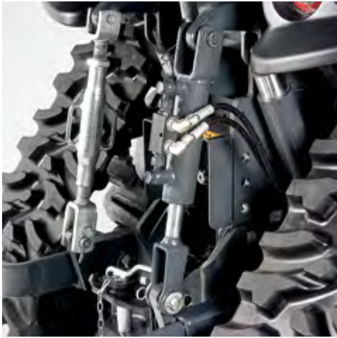
Senkrechte, hydraulische Zugstange, über den Joystick vom Fahrersitz aus einstellbar.
